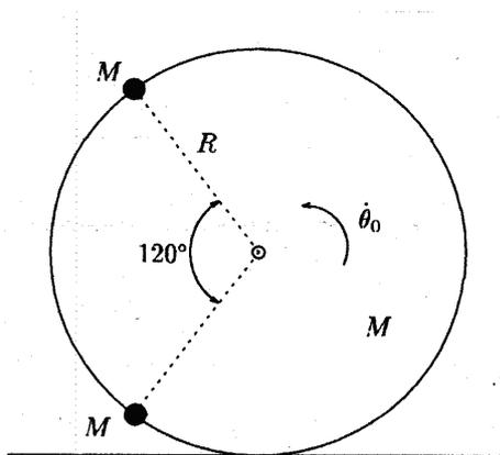
3.- Un disco Homogéneo de masa  $M$  y radio  $R$  rueda sobre una recta horizontal manteniéndose en un plano vertical. En el perímetro del disco y a  $120^\circ$  están situadas dos masas puntuales  $M$ , de forma que no estorben la rodadura del disco, en el instante dado el conjunto está situado con las dos masas puntuales en una misma vertical (ver figura), y con velocidad  $\dot{\theta}_0$ . Para este instante usando la teoría de la cinética de los sistemas de partículas, se pide:
