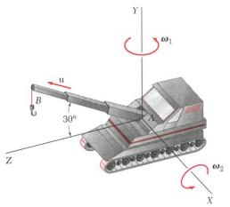
**4.-** La grúa que se muestra gira a la razón constante  $\omega_1 = 0.25$  rad/s, simultáneamente, la pluma telescópica desciende a una velocidad constante  $\omega_2 = 0.40$  rad/s. Si se sabe que en el instante indicado la longitud de la pluma es de 6 m y que aumenta a la velocidad constante u = 0.45 m/s. Usando coordenadas cilíndricas, determine la velocidad y la aceleración del punto B.
