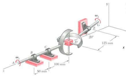
**5.-** Dos flechas AC y EG, que se encuentran en el plano vertical yz, se conectan mediante una junta universal en D. La flecha AC gira con velocidad angular constante  $\omega_1$  en la forma indicada. En el momento en el que el brazo de la cruceta conectada a la flecha AC está en la posición vertical, determine la velocidad angular de la flecha EG.
